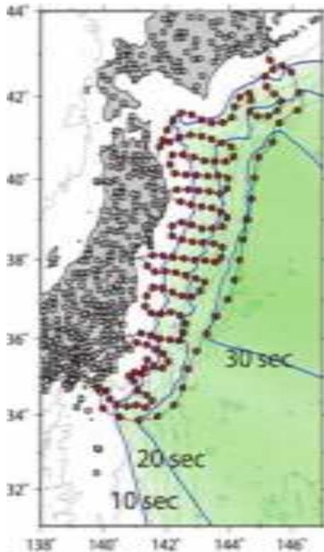
透過設置海底觀測網，能比現狀提前多久偵測出海溝型地震的發生？（緩衝時間）
