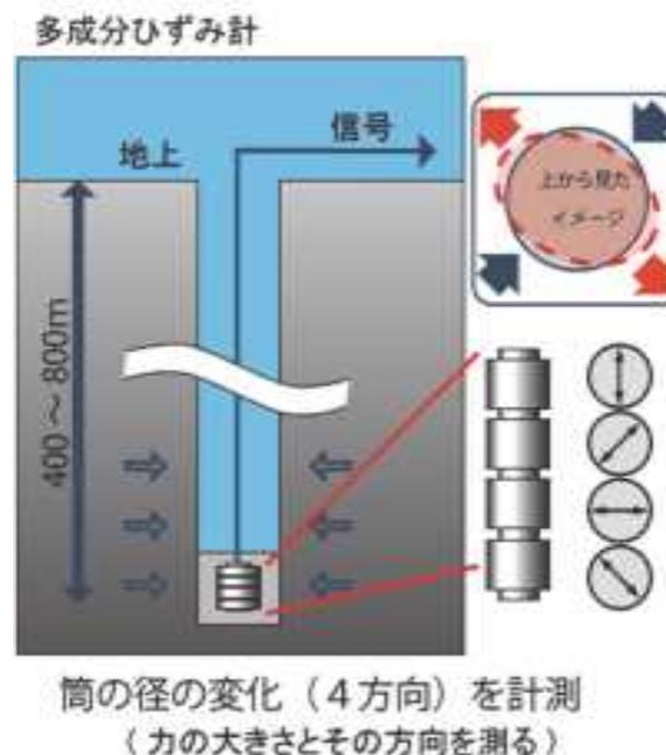
觀測精度: 可觀測至將 $1\text{cm}^3$ 的彈珠放入 $1000\text{m}^3$ 的水池時之體積變化。
