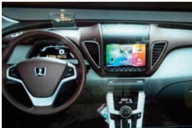
(12) 注目したいのは HTC と共同開発した IT 系の情報システム。ダッシュボードの中央下にはスマートフォンのドッキングステーションが装備される。ナビ、走行情報のチェックだけでなく、ディスプレイ上でスマートフォンがそのまま利用できる。メールチェック、ネット検索、デジカメで写した動画や画像のチェックなど。利用するかどうかは別として・・・、車の中でフェイスブックやツイッター、YouTube やゲームなどのエンタメアプリも利用できる。
