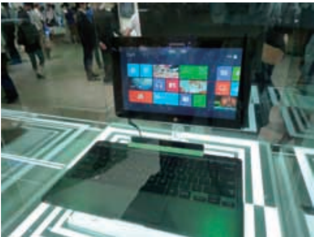
【写真16】 サムソン(Samsung)の自信作で画面が外せるタイプ。基本的に他の液晶一体型同様据え置きで使うが、前述の通り液晶部分を取り外してタブレットとしても使える。このタイプのモデルはASUSなど他のPCメーカーからも製品が発表されていた。
