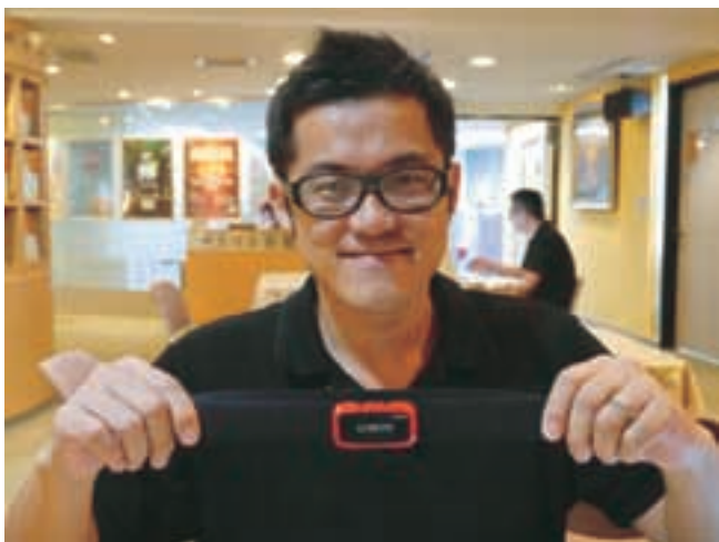
【写真 15】ベルトタイプは体に直接フィットさせてノイズを拾わない安定した測定ができるのがメリット。
