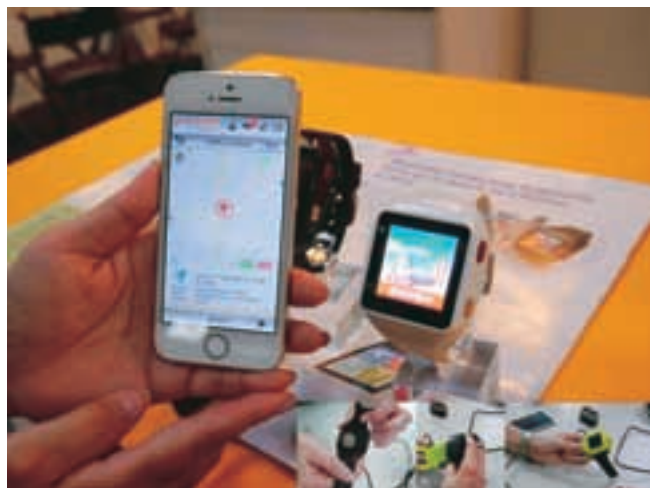
【写真18】GPS 機能でお年寄りの見守り。位置確認、緊急ホットライン、薬を飲む時間を知らせるアラーム付き。
