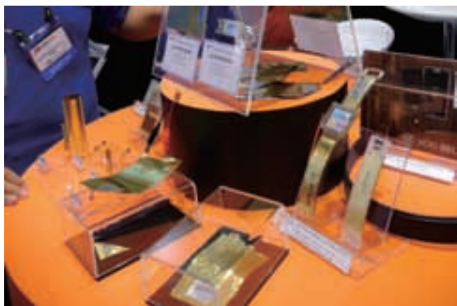
厚みはわずか0.36mm、3Dプリンタで出力した特殊な形状の成型部品に、このバッテリーを組み込んで使うとオリジナルバッテリーができる
