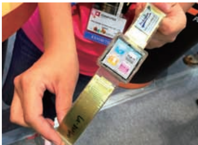
自由自在に折り曲げることもできるので、時計のベルトの中やスマートフォンケースのヒンジにあたる部分などに組み込むことも可能
