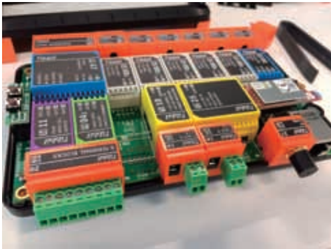
写真 17 ブロックのひとつひとつがそれぞれの機能を果たすモジュール。ブロックを並べるようにして必要な機能を基板に組み込む。
