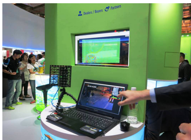
写真 25 64 個の集音マイクがそれぞれ違った方向から来る音を捉え、「音」を映像としてモニターに映し出す
