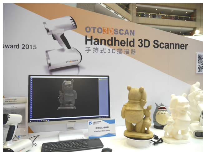
写真5 こちらは手に持った装置を動かして物体をスキャンするハンディ 3D スキャナー
