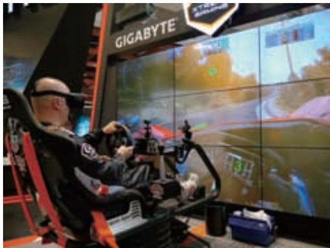
写真 16 車の走行に合わせてコックピットは振動し、衝撃が加わり、車の加速とともに G を感じる。HMD でレースの世界に没入する
