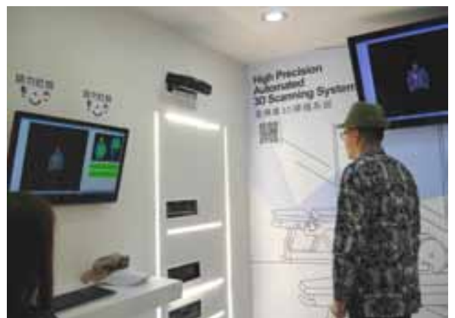
写真4 ターンテーブルに立った人を360度全身スキャンする3Dスキャナー
