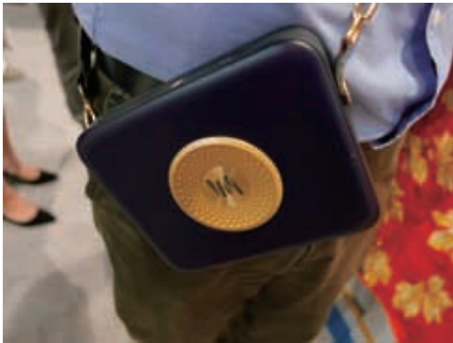
写真16 スピーカーを搭載していない拡声器。無線LAN (Wi-Fi) の基地局として動作し、説明は各自が持っているスマートフォンで聞く。レシーバーを準備する必要なし。コストダウンにもなる
