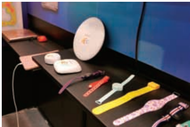
写真6 壁に立てかけているものが受信デバイス、発信デバイスは腕時計タイプ。天井に受信デバイス設置し、発信デバイスから発信されるビーコン（電波）で入射角度を測定する
