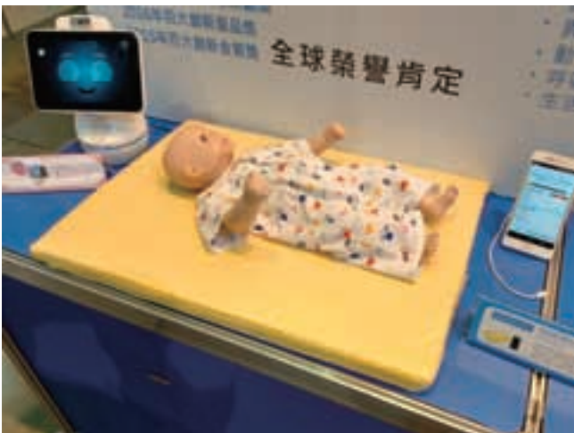
写真9 センサーが入ったベビーマット。乳児の動きをマットを通じて伝わる振動で検出。お年寄りの介護・看護の分野でも実績を積んでいる
