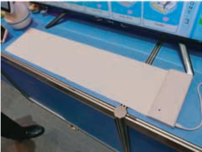
写真8 光ファイバーが入ったマット。振動による光ファイバーの変形で内部を通る光が減衰することを利用し、独自の演算方法で分析。呼吸・心拍数・脈拍・血圧・睡眠分析・体の動きなどを高い精度で取得する
