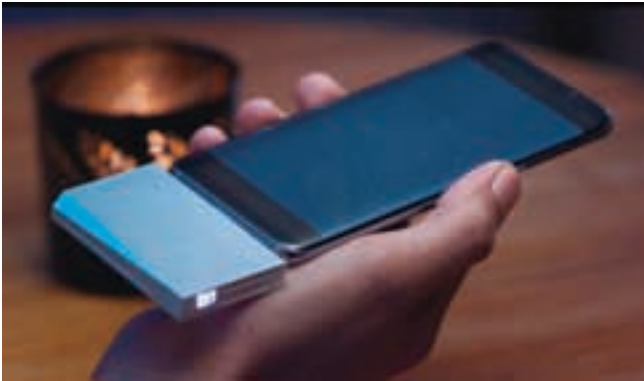
写真4 スマートフォンのUSB Type-C 端子に接続するだけで使える。大きさも7×4センチ、厚さは0.95センチ、重量30gと非常にコンパクトにまとめられている
