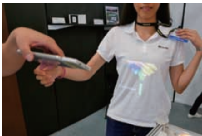
写真3 凸凹のある衣類の上でも焦点があった映像がシャツにしっかりと映し出される。距離により投影される映像の大きさは変わるが、ピント合わせがいらないのが特徴
