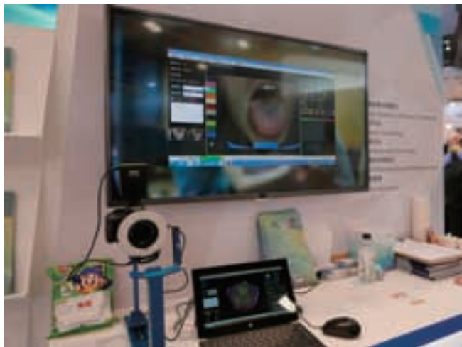
写真14 市販のデジカメなどを使いコストを抑えた。容易に入手可能なハードウェアで開発した自動舌診システム
