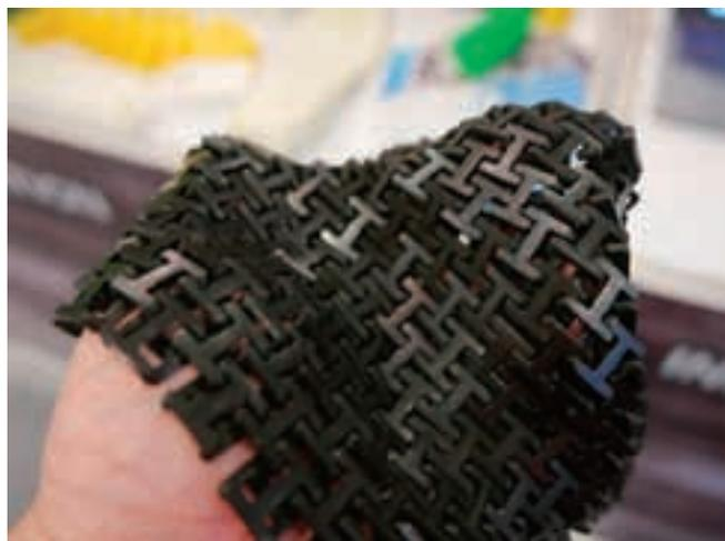
写真 13 部品を先に作って後で組み合わせたわけではなく、最初から最後まで同社の 3D プリンターで作成
