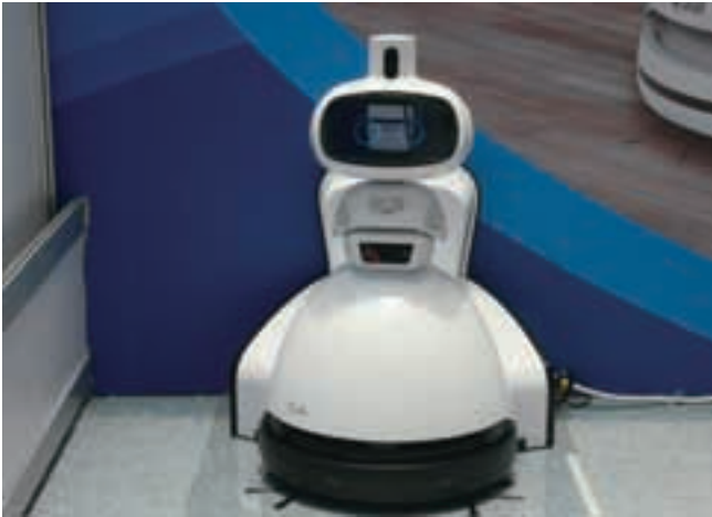
写真 23 Qubi は EQL (宜優科技) のサービスロボット、足元に自動掃除機を収納する。量産を受け持つのは台湾大手 EMS ベンダーである Quanta (廣達)
