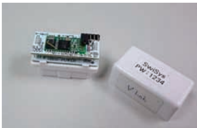
写真18 小型のブリッジモジュールを基板から独自開発
