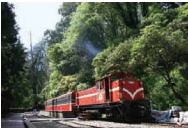
進行方向を変えながら勾配を上がっていくスイッチバック。連続するスイッチバックというのは珍しい。スイッチバックに設けられた神木駅に停車中の列車。
