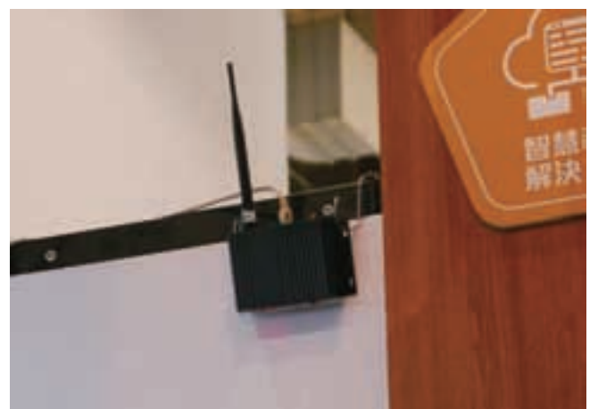
写真 10-3 Dmatek 社のビーコン受信装置
