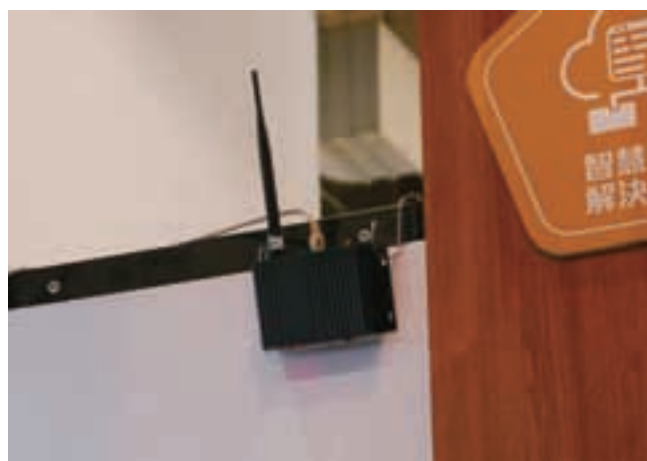
写真 10-3 Dmatek 社のビーコン受信装置
