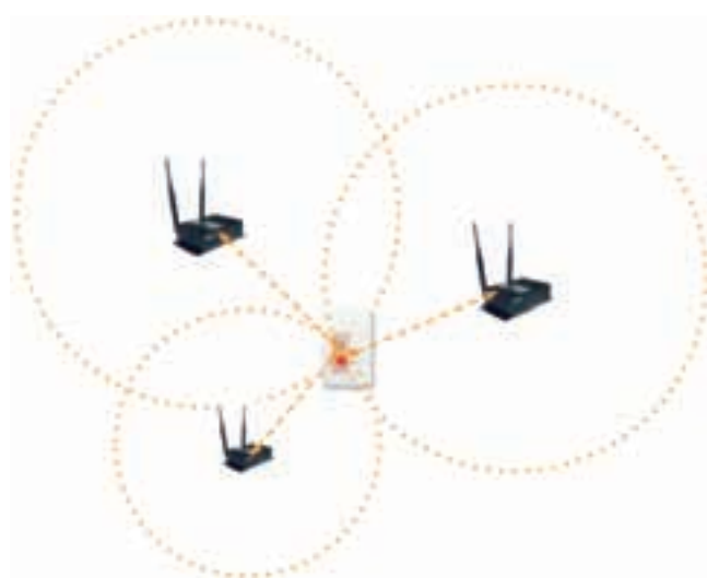
写真 10-2 ToA (Time of Arrival) 方式の概要
