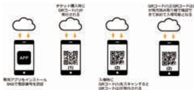
写真 11-1 なりすまし防止の仕組み
