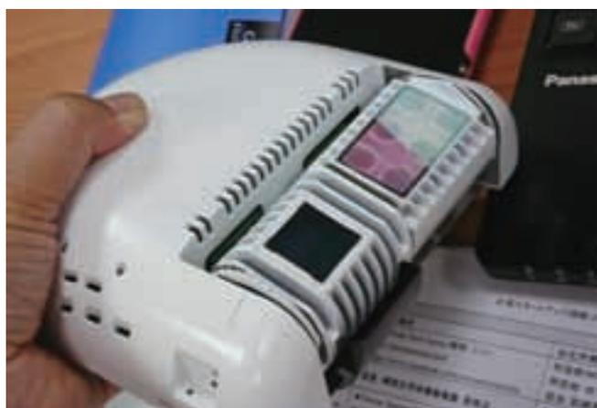
写真5 1つの病室全体をカバーする。ToF (Time-of-Flight) とミリ波レーダーで異常を感知
