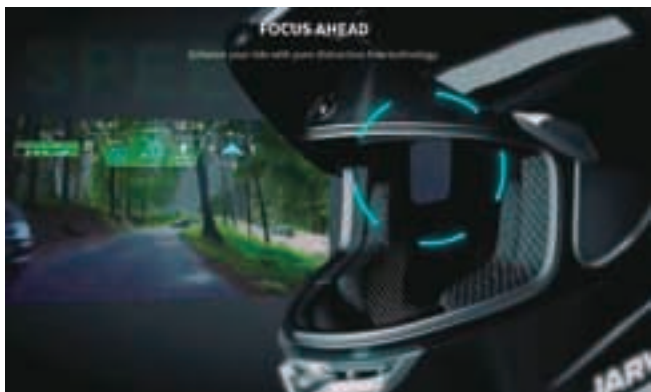
写真1 JARVISH X-AR スマートヘルメット、丸い枠の部分がヘッドアップディスプレイ (HUD)
