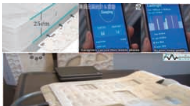
写真 26 厚さ 25cm のマットの下でも大丈夫。微妙な空気の流れを感知する(ForeAider ホームページより引用)
