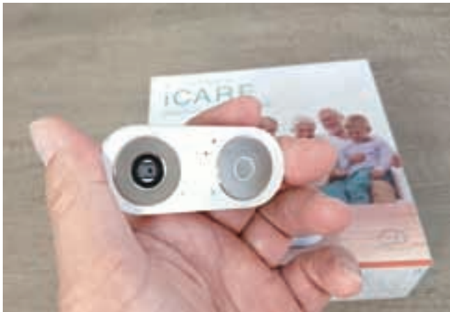
写真 22 電極に両手の指を押し付けると 60 秒で 8 項目のデータ計測が可能
