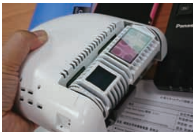
写真5 1つの病室全体をカバーする。ToF (Time-of-Flight) とミリ波レーダーで異常を感知
