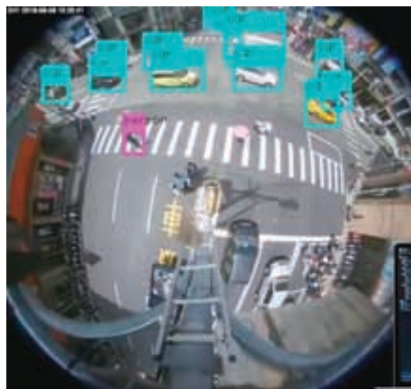
写真 18 画面の中で車を認識すると「Car」と表示される (ioNetworks 資料より)
