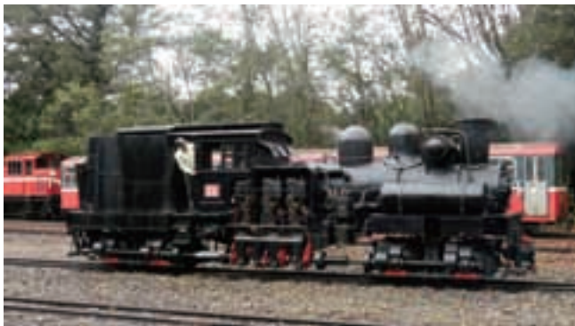
片側にピストンが並び、左右非対称のデザインとなっている。全輪駆動で勾配と曲線に強いのが特色とされる。
