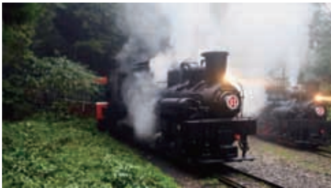
シェイ式蒸気機関車はアメリカの発明家であるエフライム・シェイによって考案された歯車式蒸気機関車。1881年に特許を取得している。
