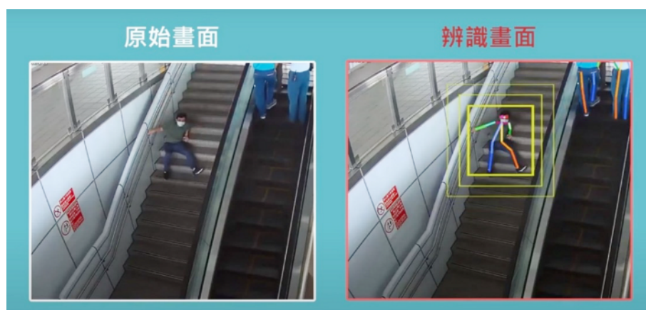
図説：転倒検知システムは画面上の人物を棒で骨格を表すような形に変換できます。(写真：財団法人資訊工業策進会)
