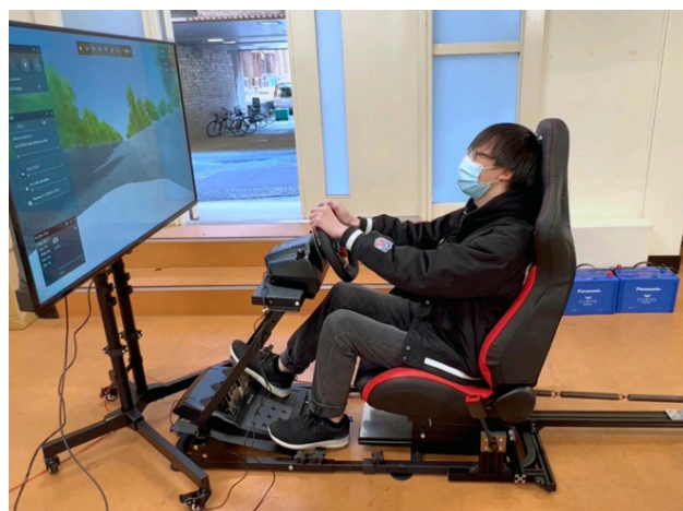
自動車安全技術開発プロジェクトで開発した「速度超過防止のためのシミュレーションシステム」。
