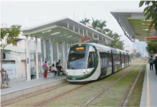
写真-8 高雄LRTの駁二蓬萊（ポーアーボンライ）停留所に停車中のスペインCAF（カフ）社製の低床式電車ウルボス（Urbos）。この間に充電するため、高架線がないのが特徴である。LRTの停留所に哈馬星（ハマセン）があるが、これは日本統治時代の「濱線（はません）」の音からつけたもの。（2018年12月21日）
