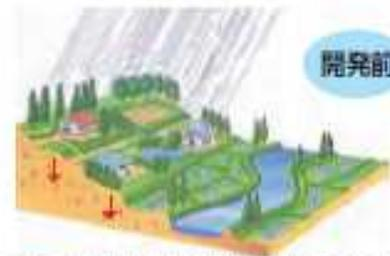
雨水の大半は地中へしみこんで、水田や溜め池のために、川への流入が抑制されます
