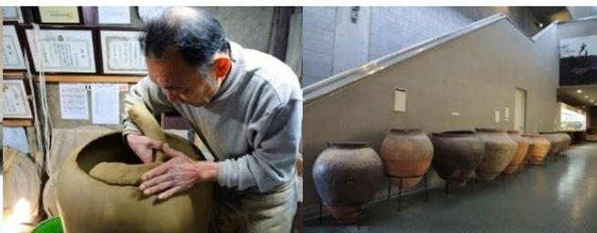
圖 8 常滑市指定無形文化財的常滑燒工法「大物手擠坯」的保持者傳統工藝士前川賢吾先生。常滑的茶陶發展遲緩，卻因而保持了大型容器的製作技術。
