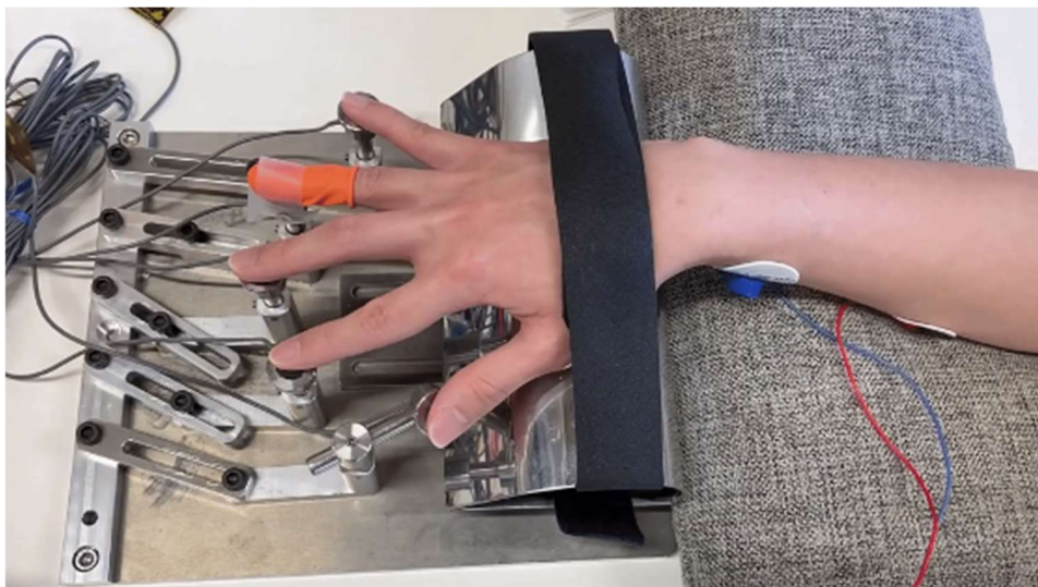
図 11 各指先での押す力を計測するリハビリ装置
