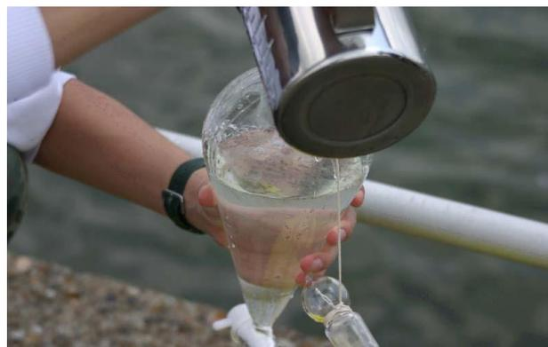
写真-2 水の試料の採取
