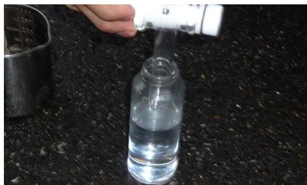
写真-1 海水、淡水の溶媒抽出
