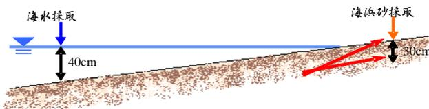
図-1 海浜砂および海水の採取
