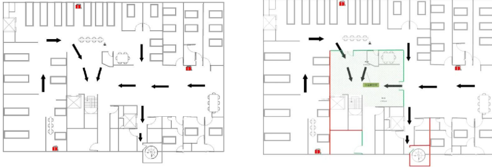
圖 7：左邊為 A2 醫院開放式呼吸照護病房樓層，右邊為劃分加強直通樓梯區劃性能並保護升降機來設置待援區的改善方案。
