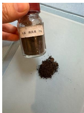
圖19 燒吳須顏料的研磨養成
